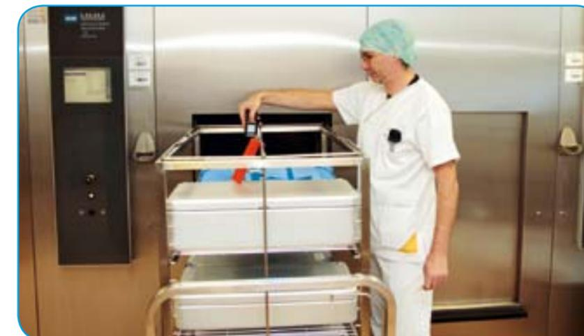
Jedes Sieb wird gescannt bevor es in den Sterilisator eingefahren wird. Nach der Sterilisation erfolgt die Freigabe der Siebe bzw. die Zuordnung zum jeweiligen Ziel ebenfalls mittels Scanner. So ist eine lückenlose Rückverfolgbarkeit garantiert. Im Bild: Bernhard Miller, Leiter der ZSVA.
