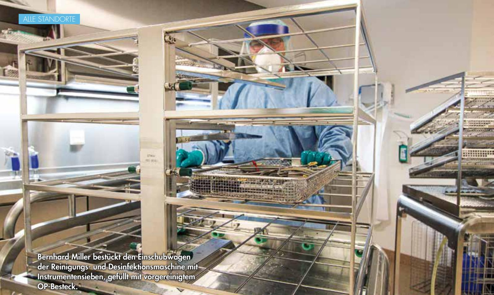
Bernhard Miller bestückt den Einschubwagen der Reinigungs- und Desinfektionsmaschine mit Instrumentensieben, gefüllt mit vorgereinigtem OP-Besteck.
